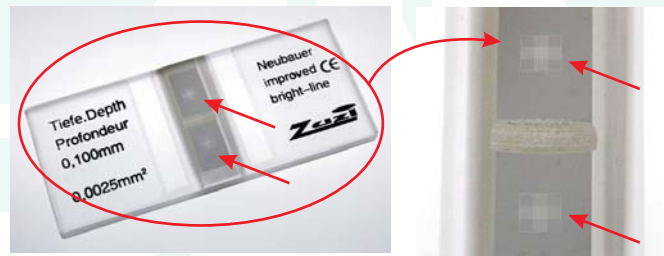
Fig. 1: Foto y esquema de una cámara Thoma
