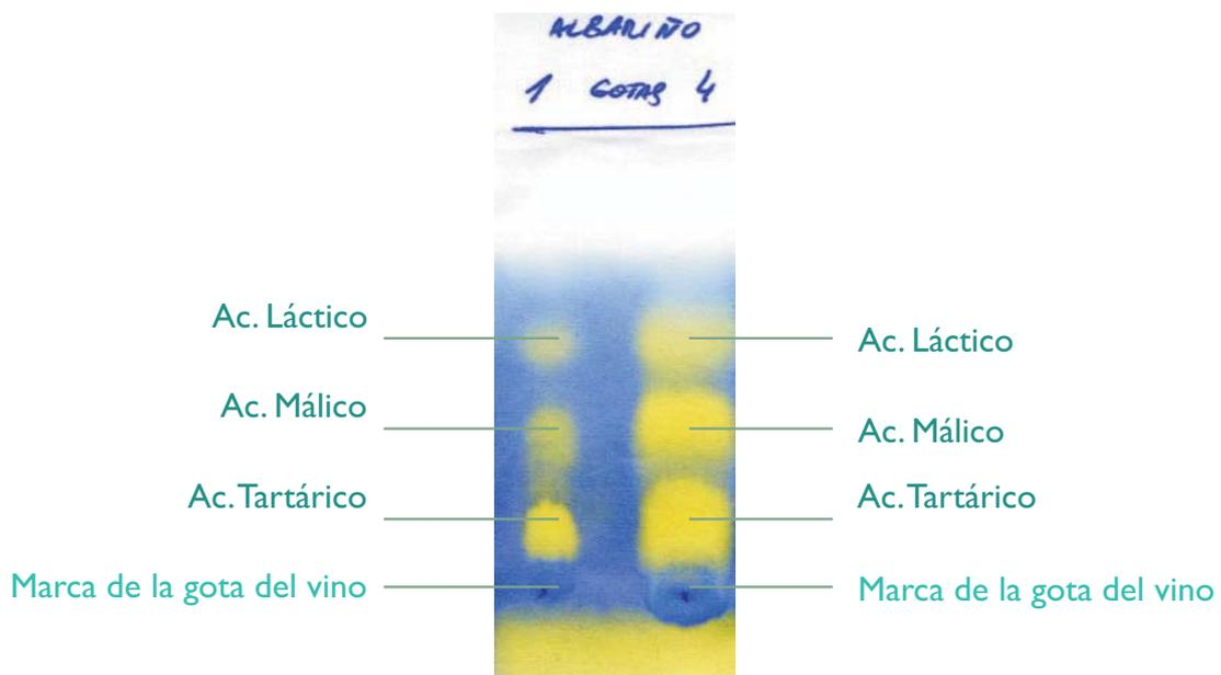
Muestra de blanco Albariño con 1 gota (izquierda); 4 gotas (derecha): Básicamente la diferencia entre una gota o varias es el tamaño e intensidad de la mancha. Se aprecian mejor con más gotas. Ideal entre 3-4 gotas. Proceso de FML iniciado.
