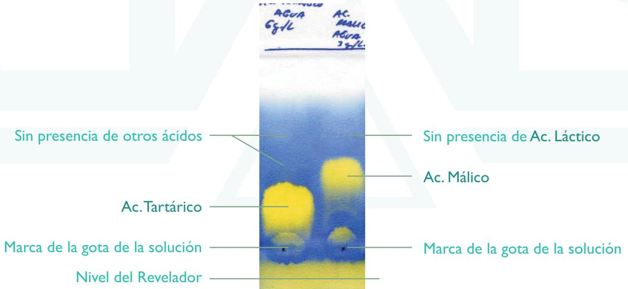
Muestra de Acido Tartárico disuelto en agua, 6gr/L (Izquierda); Muestra de Acido Málico en agua, 3 gr/L(Derecha):
