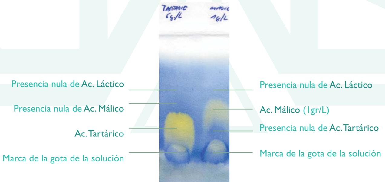
Disolución de Ac. Tartárico, 6 gr/L (izquierda); Disolución de Ac. Málico, 1 gr/L (derecha): Se aprecia claramente la sola presencia de un ácido u otro.
