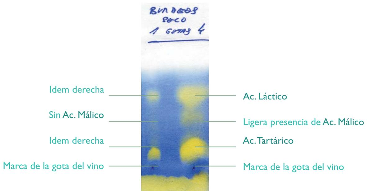
Burdeos gota seca antes de sumergir en Revelador, 1 gota (izquierda); 4 gotas (derecha): Con más gotas, mayor intensidad de la mancha. Proceso de FML prácticamente acabado.
