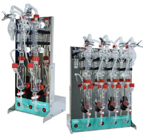
Equipos destiladores para análisis de SO<sub>2</sub> por el método Paul-Rankine de una forma rápida y práctica. Distillation units for SO<sub>2</sub> analysis by the Paul-Rankine method in a fast and practical way.
