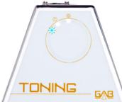
Led #1 y Led #2 , blancos, parpadeando: Ajuste no OK. Repetir análisis con menor volumen de muestra y usar el factor multiplicador adecuado.
