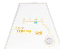
Leds #1 #2 y #3 encendidos: Testeando final de análisis si perdura así durante 10 segundos el análisis habrá acabado, sino habrá que echar alguna gota más de Líquido de Valoración. Leds #1, #2 and #3 lighted on: Testing final analysis if lasts during 10 seconds end of analysis otherwise some more drops of titration liquid will be needed.
