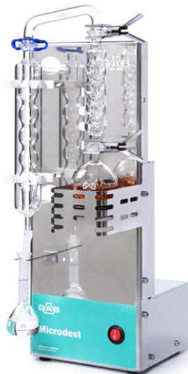
**02. Conectar el equipo y esperar a destilar y recolectar hasta unos mm antes del menisco en el matraz aforado.** Connect the equipment and wait to distill and collect up to a few mm before the meniscus in the volumetric flask.
